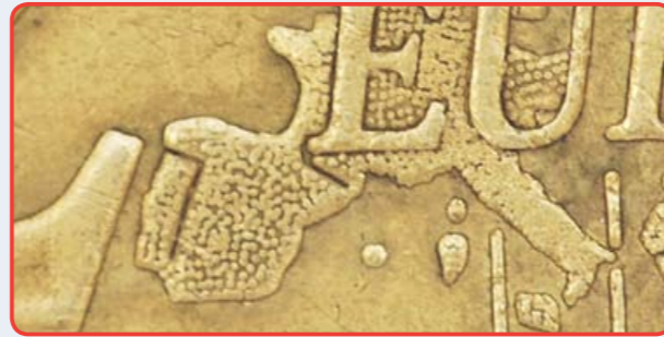
KRIVOTVORINA – ispupčene točke – pogreška pri otkivanju
